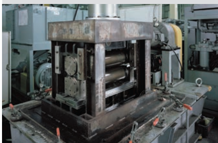
Испытательный стенд для подшипников, использующихся в направляющих валках машины непрерывного литья
