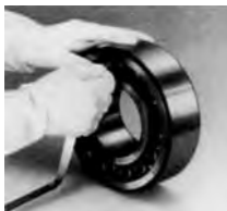
Рис. 1. Проверка зазора подшипника на верстаке.
